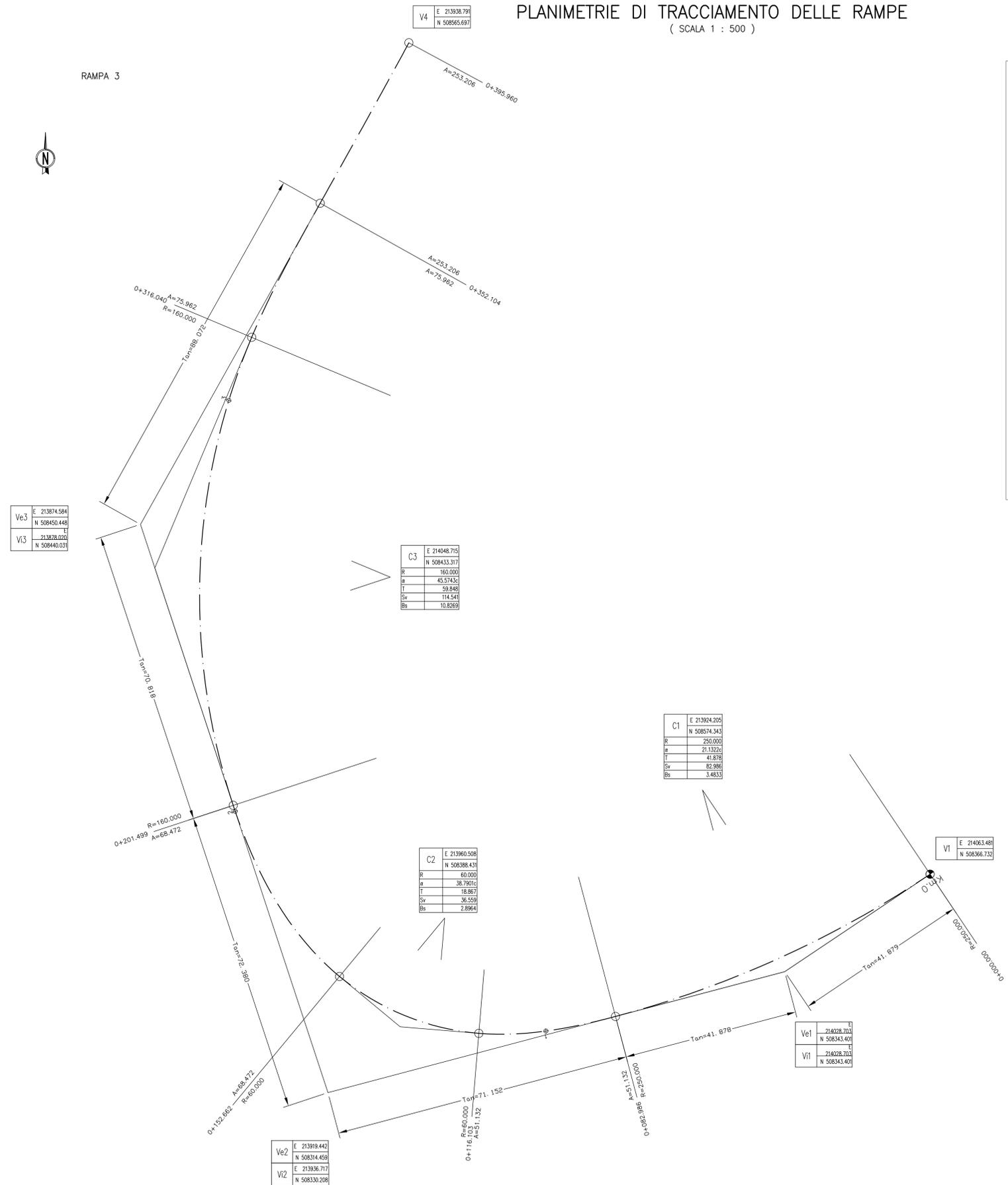
N.B. Per il tracciamento utilizzare fattore di correzione topografica = 1
