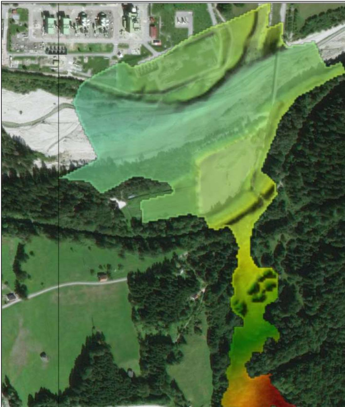
**Figura 18** modello DTM ottenuto dall'interpolazione del rilievo
