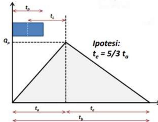
**Figura 16** Schema idrogramma triangolare utilizzato per calcolo portata
