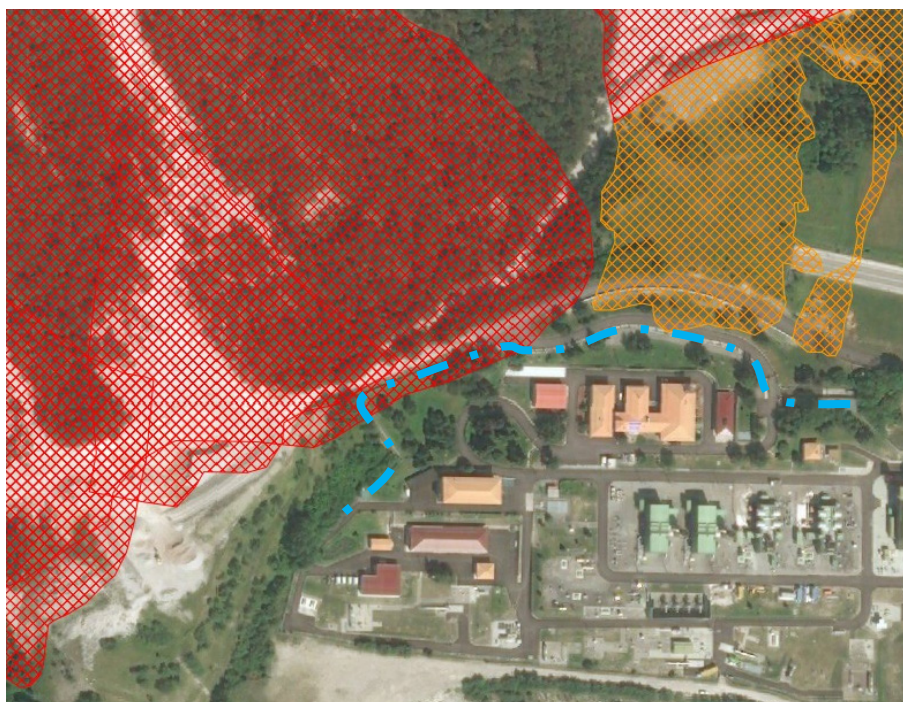
Foto 6: l'area di lavoro è esterna alla pericolosità geologica (da frane) e dal vincolo idrogeologico. La linea tratteggiata punto-linea rappresenta il limite a monte dell'impianto
