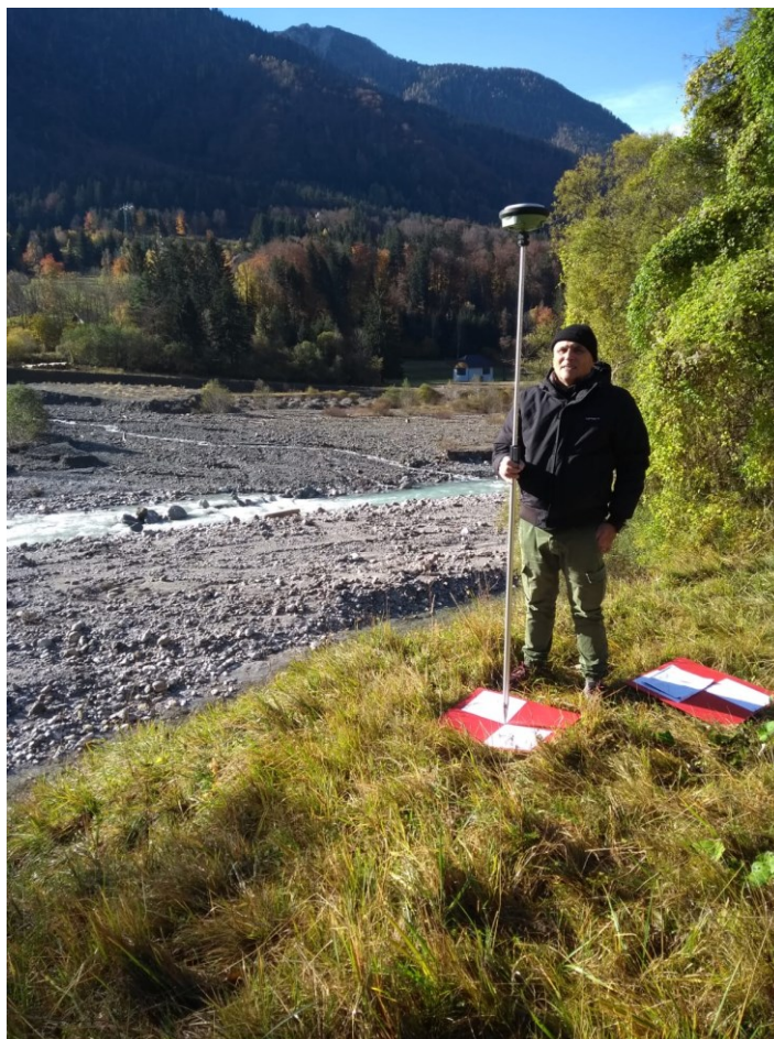
Figura 4 – Esempio di misura di marker di appoggio del rilievo fotogrammetrico
