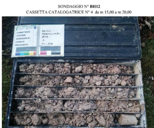
Figura A/3 – Documentazione fotografica sondaggio BH12 (estratto dal Doc./8/)
