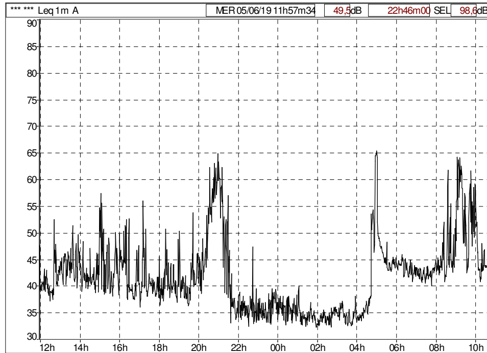
Figura 12: rilievi fonometrici ante operam (posizione A, time history)
