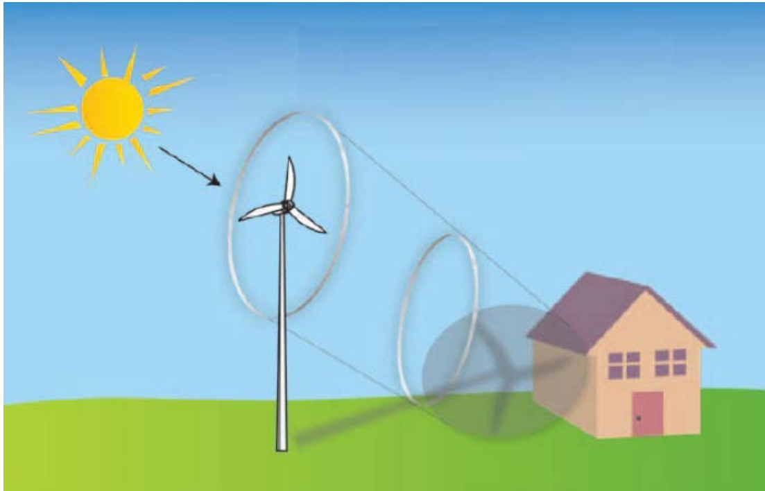
Figura 25. Illustrazione del fenomeno di shadow flickering
