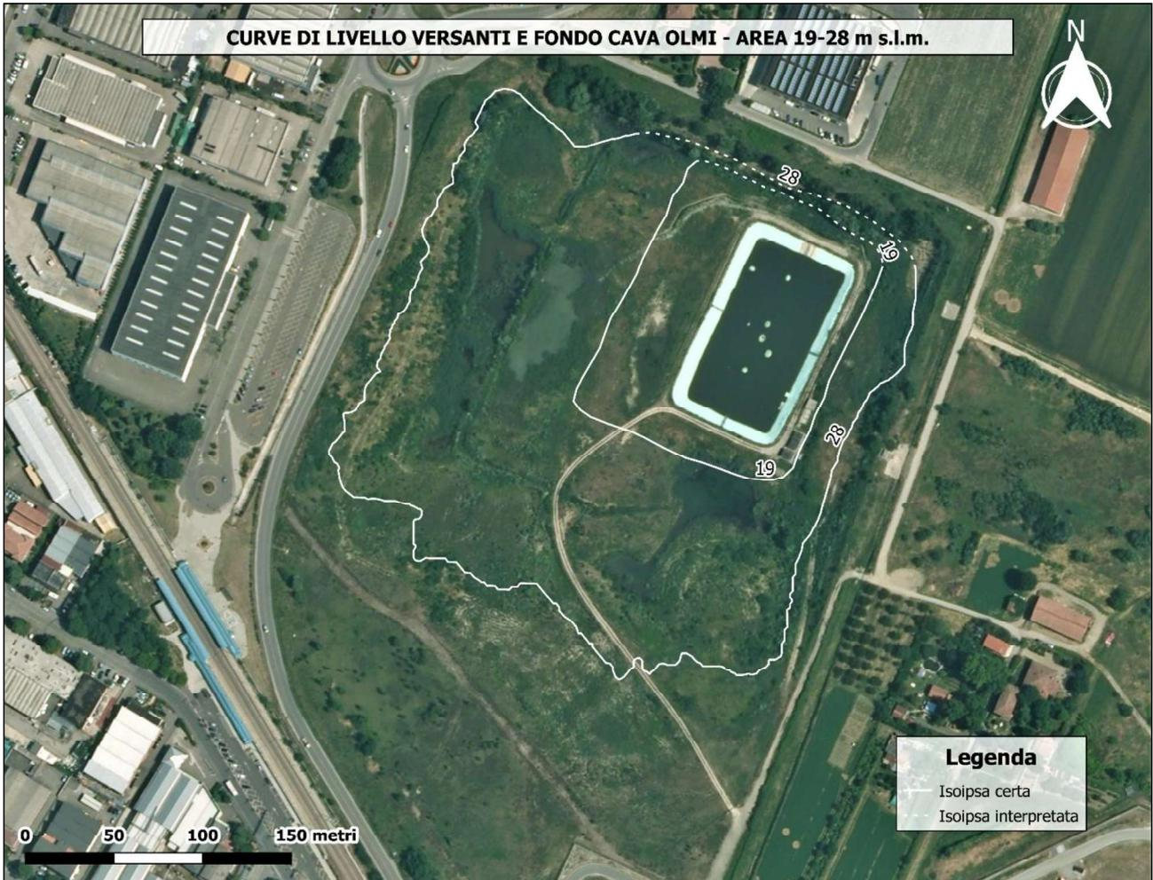
*Figura 41 – Area compresa tra le quote 19 e 28 m s.l.m., all'interno della quale sono state individuate le zone di abbancamento sui versanti ovest e sud della cava*
