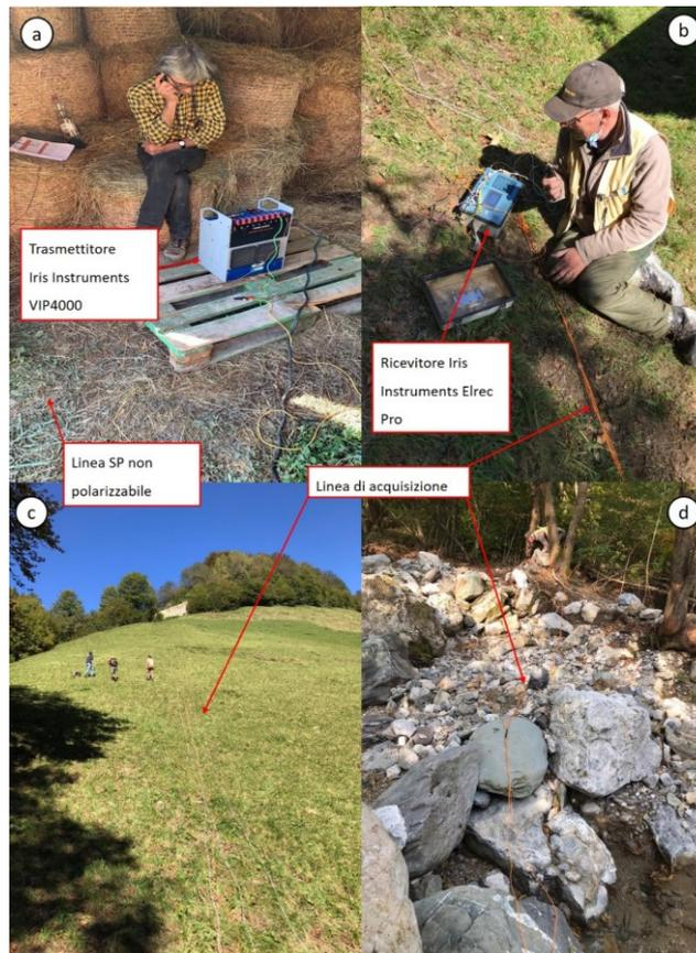
Figura 11: prospezione geoelettrica (polarizzazione indotta e resistività) con metodologia polo-dipolo: (a) trasmettitore alla base Tx per invio segnale elettrico; (b) ricevitore in posizione mobile lungo linee di acquisizione a passo "Tx-ricevitore-picchetti" costante; (c & d) stendimento di cavetti di rame per trasferimento-registrazione del segnale geoelettrico (fonte: Alta Zinc Ltd., prospezione geoelettrica Progetto "Gorno").
