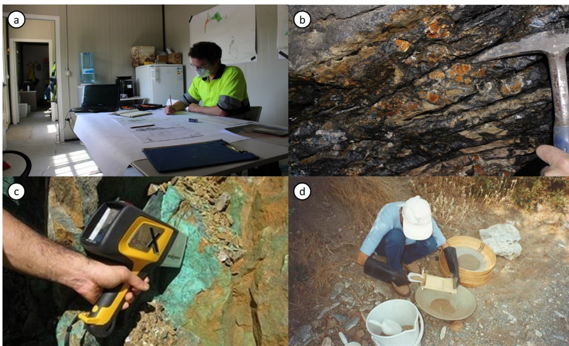
Figura 63: Raccolta di immagini rappresentative dell'attività esplorativa da piano lavori; (a) elaborazione e produzione di cartografia geologica previa mappatura geologico-strutturale (fonte: Alta Zinc Ltd., Progetto "Gorno"); (b) campionamento corpi mineralizzati (fonte: Alta Zinc Ltd., Progetto "Gorno"); (c) analisi geochimica speditiva di terreno con ausilio dello strumento pXRF Olympus Innov-X Delta (fonte: Nickel laterite
