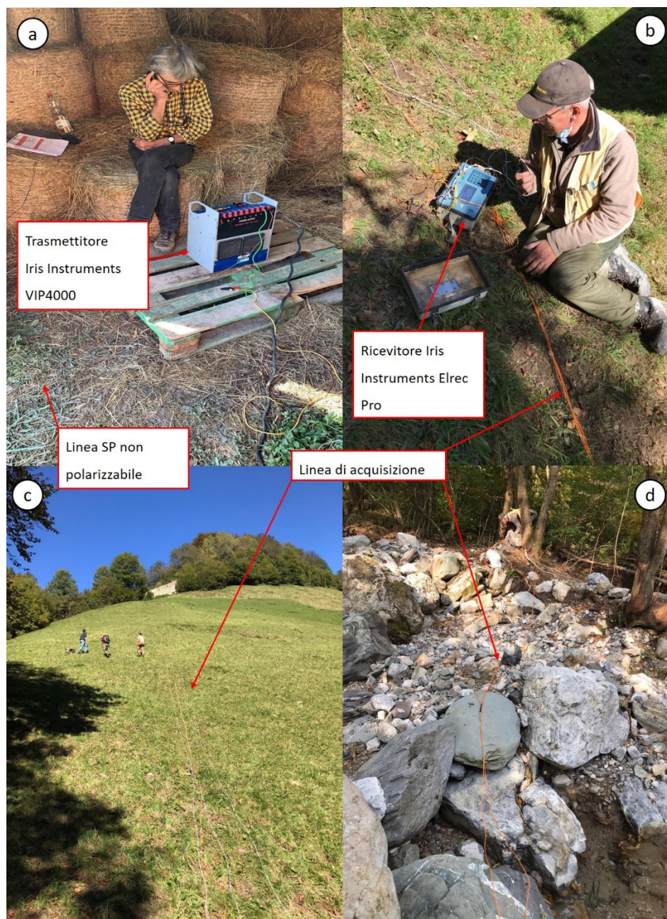
Figura 65-Prospezione geoelettrica (polarizzazione indotta e resistività) con metodologia polo-dipolo: (a) trasmettitore alla base Tx per invio segnale elettrico; (b) ricevitore in posizione mobile lungo linee di acquisizione a passo "Tx-ricevitore-picchetti" costante; (c & d) stendimento di cavetti di rame per trasferimento-registrazione del segnale geoelettrico (fonte: Alta Zinc Ltd., prospezione geoelettrica Progetto "Gorno").
