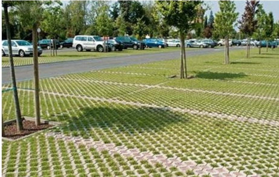
**Figura 71 – Esempio di pavimentazione in masselli autobloccanti grigiati**
