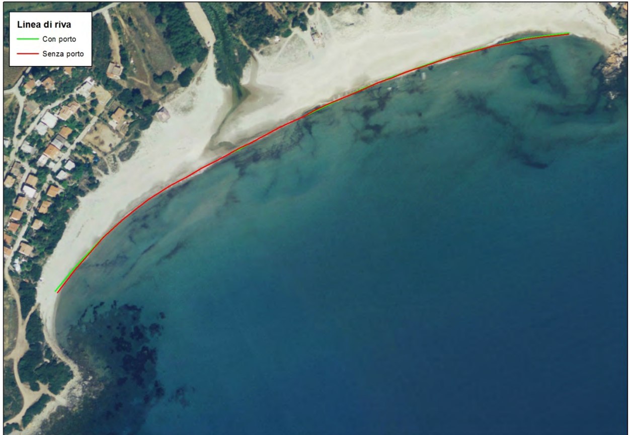
Figura 41: Risultati del modello UNIBEST. Evoluzione della linea di riva in presenza ed in assenza della struttura portuale
