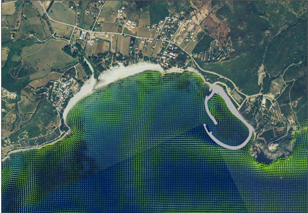
Figura 29: simulazione idrodinamica generata da un evento di grecale. Situazione di progetto
