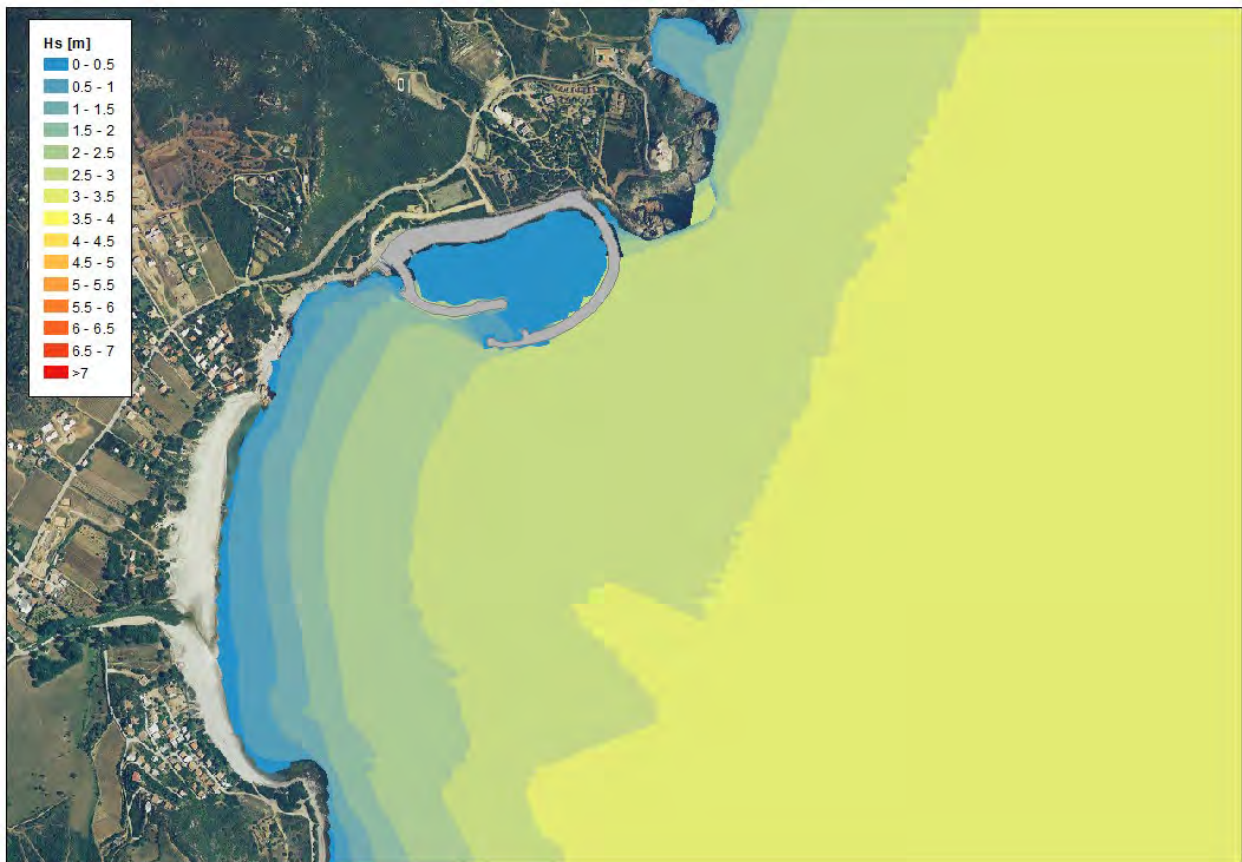
Figura 13: Restituzione simulazione di trasformazione del moto ondoso al largo e particolare in prossimità dell'area di intervento. Tr=2 anni, Dir=130^\circ , H_s=3.35 m, T_p=8.24 s; velocità vento 12.8 m/s.
