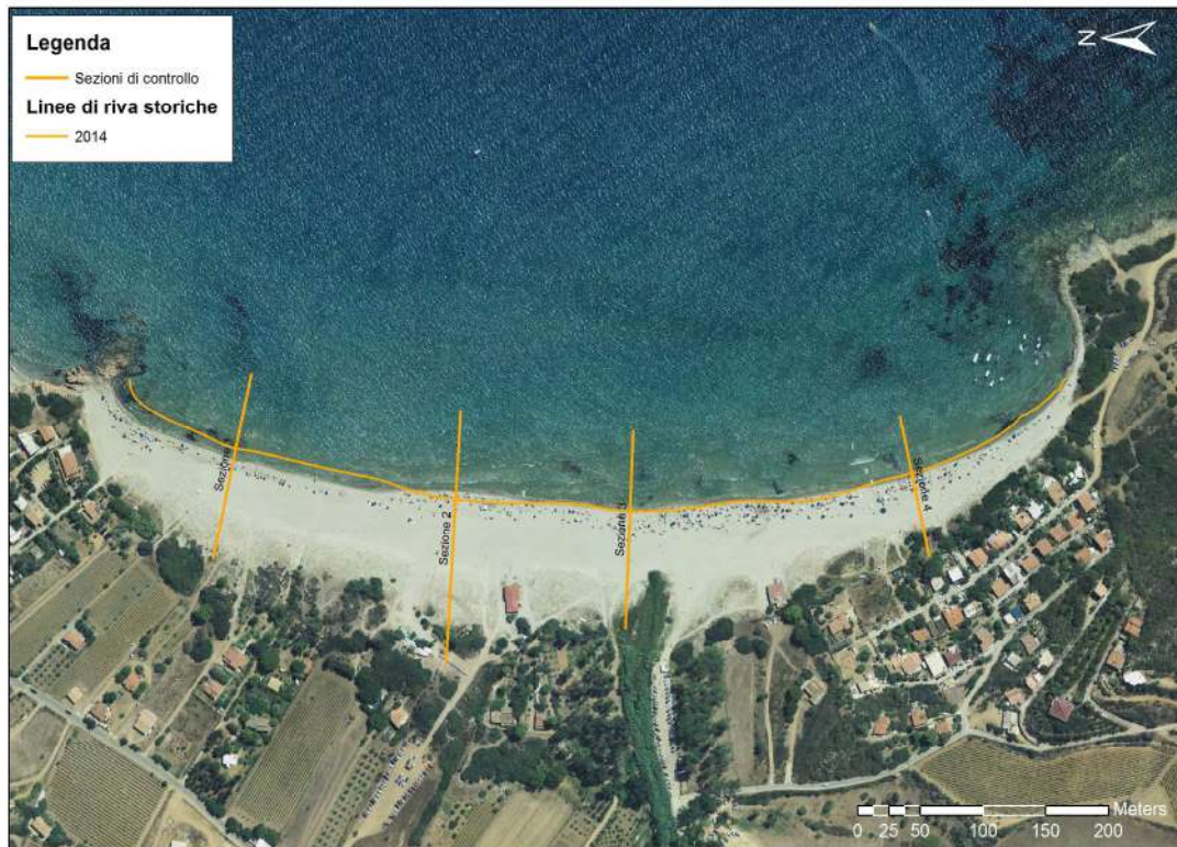
Figura 38 – Ortofoto RAS 2008; in arancio la linea di riva attuale rilevata con GPS geodetico (aprile 2014).
