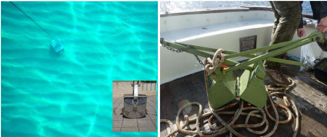
Fig. 19 – Benna tipo Ekman-Birge (sx) e Van Veen (dx).
