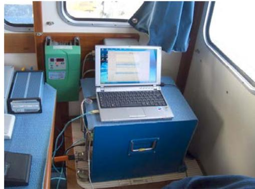
**Figura 4 : Il processore Innomar SES-2000 compact a bordo del TRER Interfacciato con un notebook di piccole dimensioni ed al DGPS FugroSeastar**
