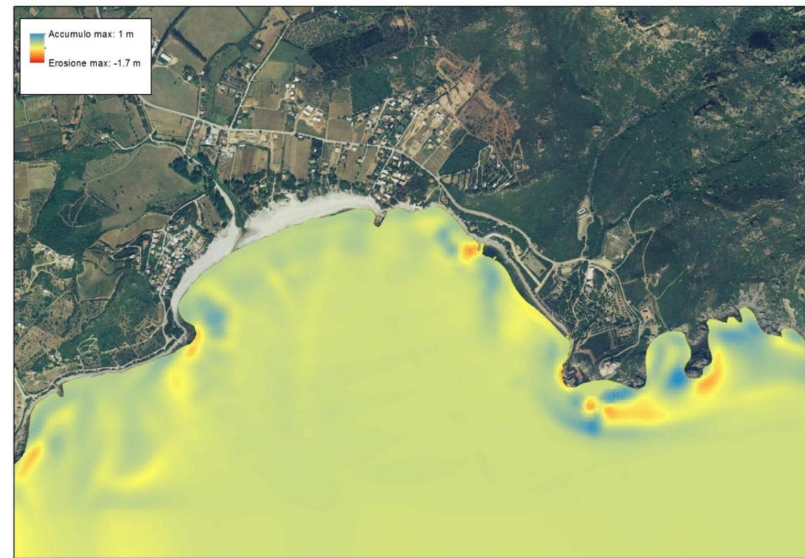
Figura 64: Simulazione idrodinamica generata da un evento di grecale. Situazione attuale espressa in termini di isolinee di sedimento. Valori negativi: erosioni, valori positivi: accumuli
