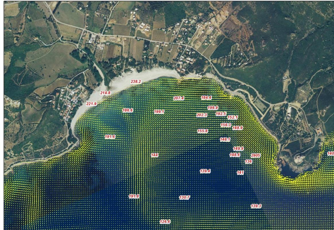
Figura 62: Simulazione idrodinamica generata da un evento di grecale con riportate le analisi granulometriche del sito.
