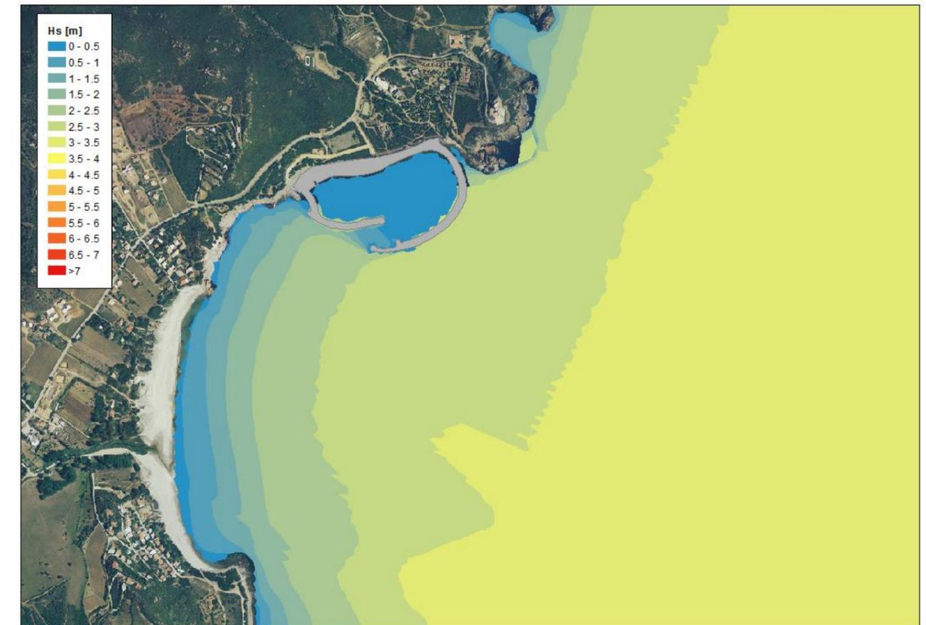
Figura 57: Restituzione simulazione di trasformazione del moto ondoso al largo e particolare in prossimità dell'area di intervento. Tr=2 anni, Dir=130°, Hs=3.35 m, Tp=8.24 s; velocità vento 12.8 m/s.
