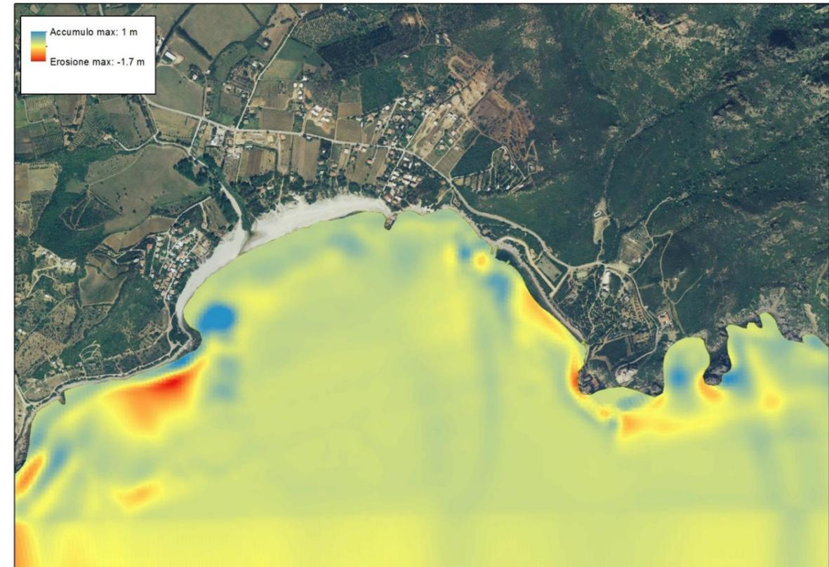
Figura 65: Simulazione idrodinamica generata da un evento di scirocco. Situazione attuale espressa in termini di isolinee di sedimento. Valori negativi: erosioni, valori positivi: accumuli
