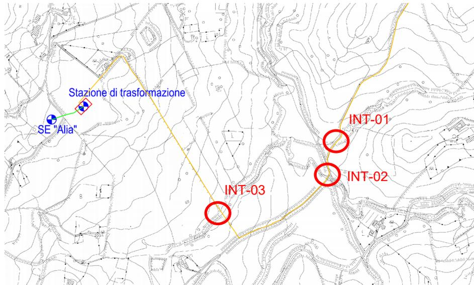
Si prevede di risolvere le interferenze attraverso la posa in tubo tramite spingi-tubo a sufficiente distanza dal limite inferiore dell'alveo. Per maggiori dettagli sulla sezione di posa, si rimanda al documento "GRE.EEC.D.73.IT.W.14180.12.003 - Planimetria cavidotti con individuazione tratti di posa".
