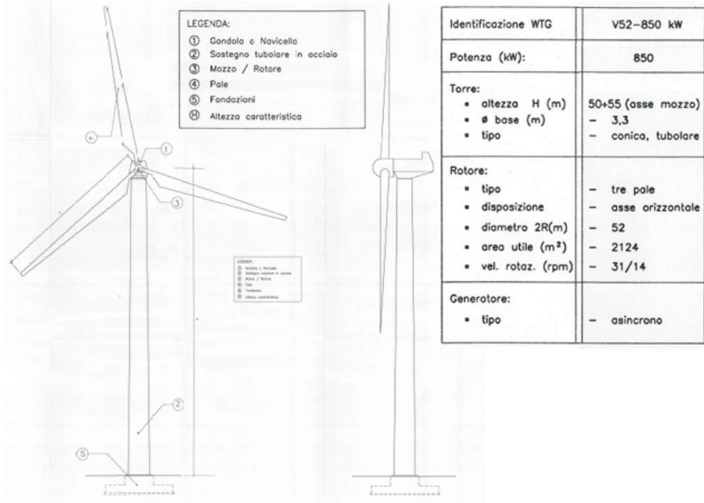
Figura 5-1: Dimensioni principali di una Vestas V52
