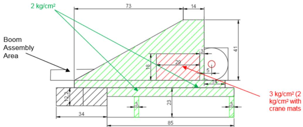
Figura 5-9: Dimensione piazzola montaggio a fine strada
