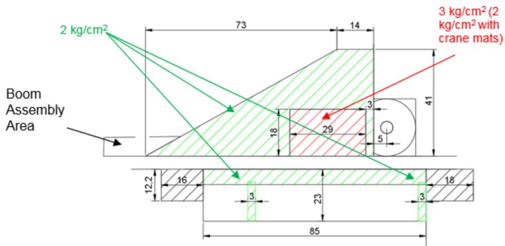
Figura 5-10: Dimensione piazzola montaggio a lato strada
