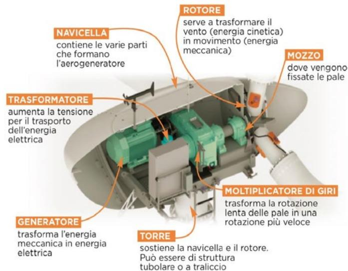
**Figura 2-2: Caratteristiche dettagliate dei componenti presenti in una turbina eolica**
