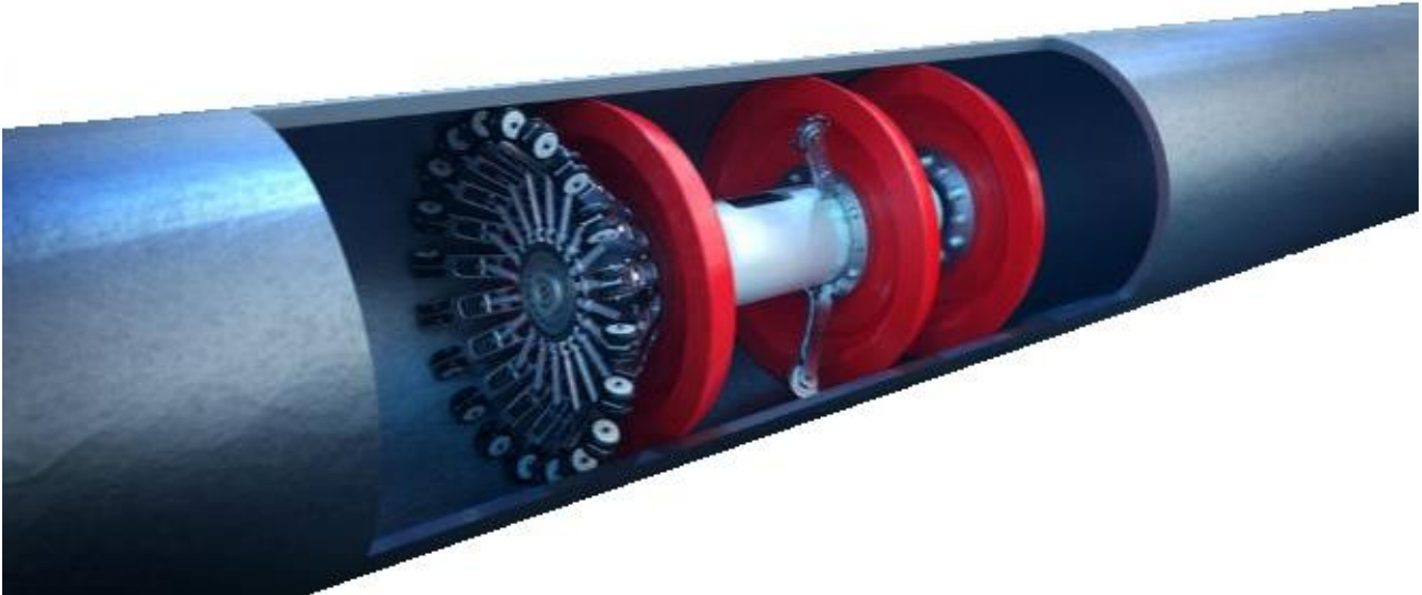
Fig. 2.13 - Pig strumentale per il controllo della geometria e dello spessore della condotta.
