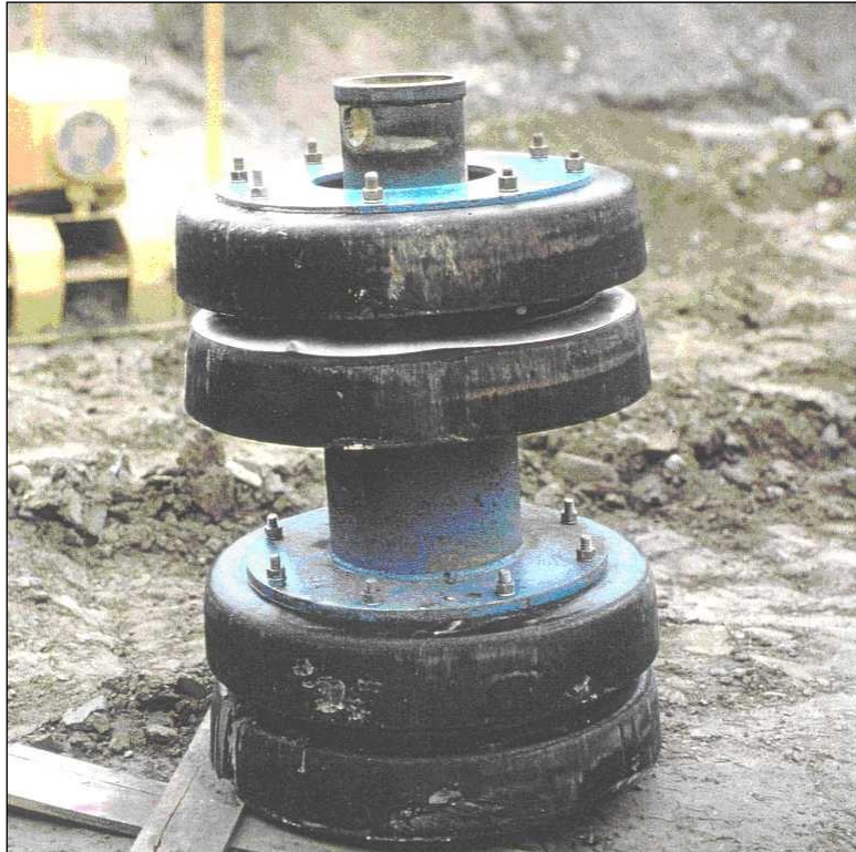
Fig. 2.12 - Pig convenzionale impiegato nelle operazioni di collaudo idraulico e di pulizia della condotta.
