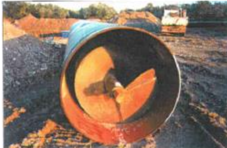
Fig. 2.1 - Coclea per trivella spingitubo
