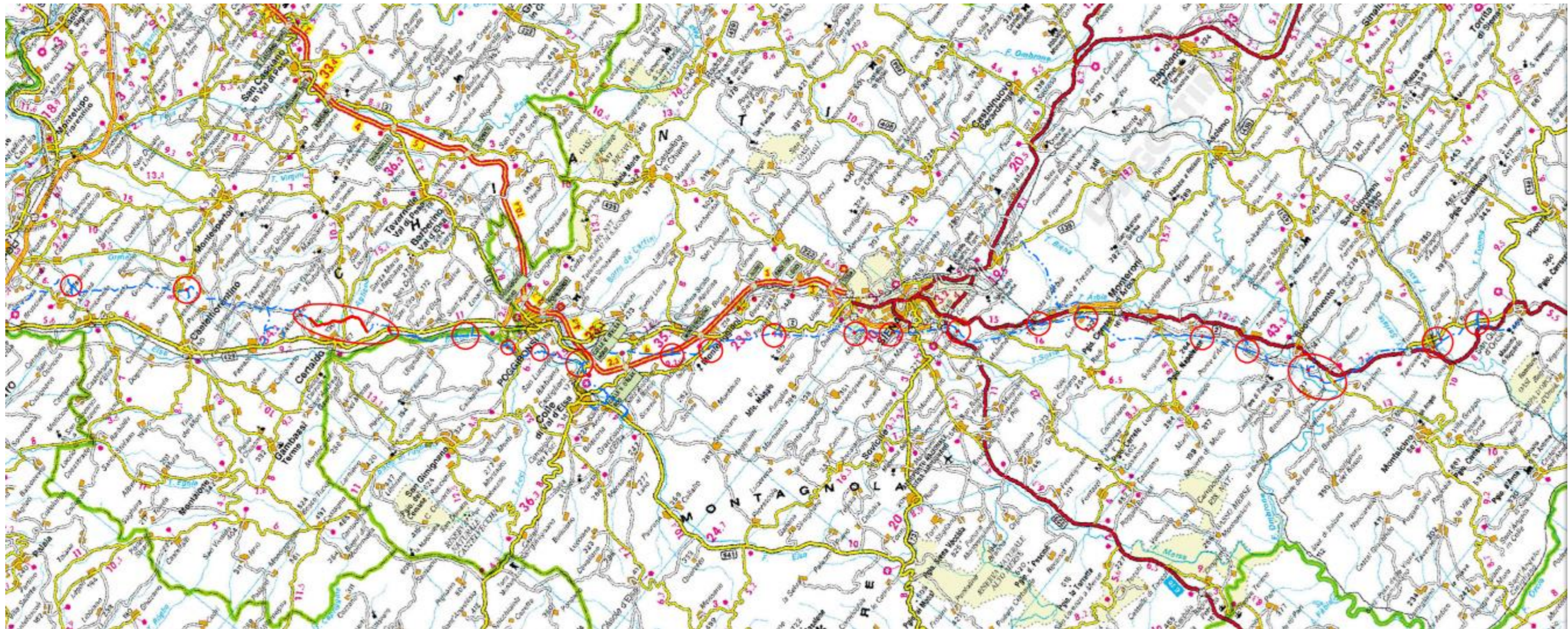
Fig. 1.1 - Inquadramento generale delle opere in progetto. In blu è riportato il metanodotto esistente, in rosso il metanodotto in progetto e in verde il metanodotto in rimozione. Le aree oggetto d'intervento sono indicate nel cerchio rosso.
