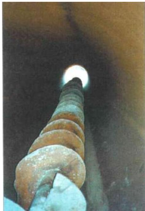
**Fig. 3.3 - Coclea per trivella spingitubo.**
