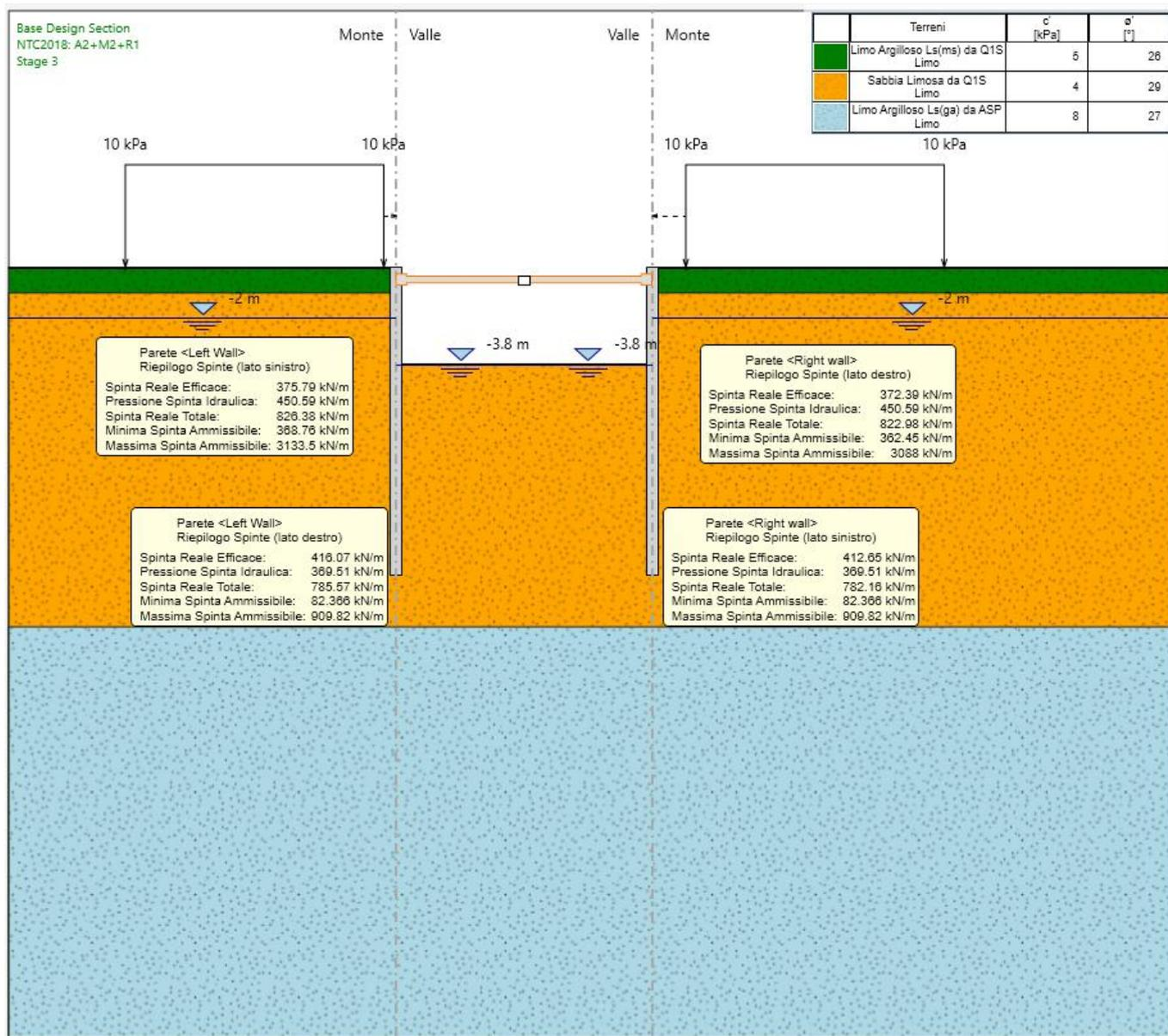
**Figura 19 Modello di calcolo e spinte**
