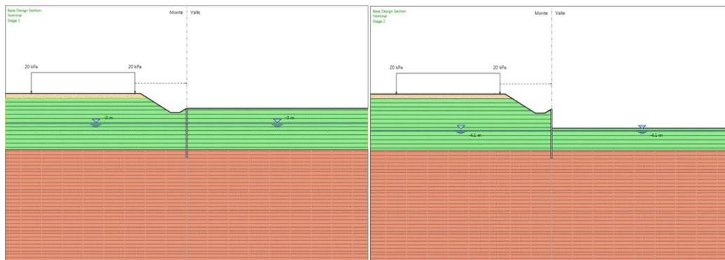
*Figura 3: Step di calcolo della paratia*
