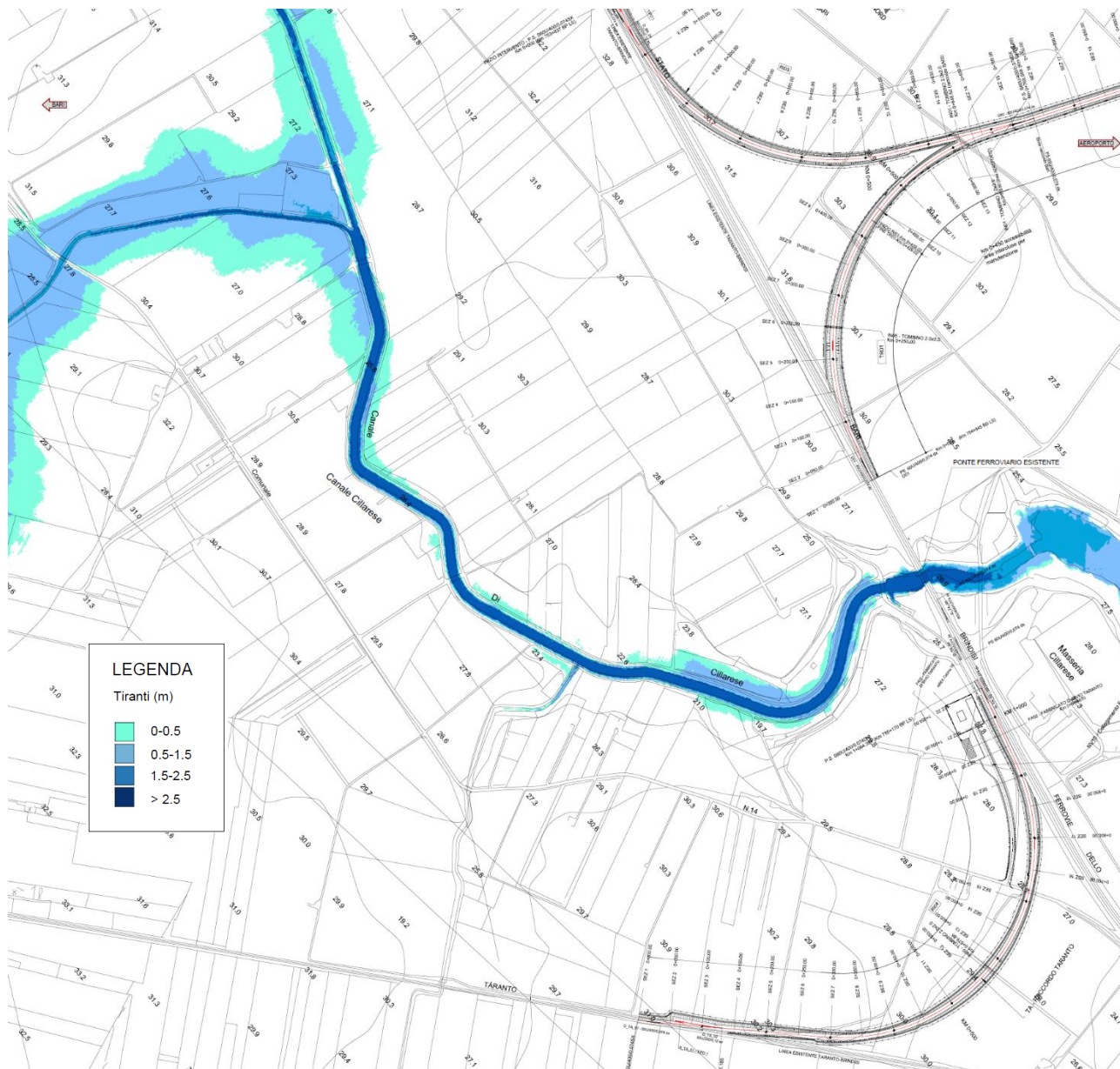
Figura 16 - Modello 2D del Canale Cillarese: aree di esondazione Tr 30.
