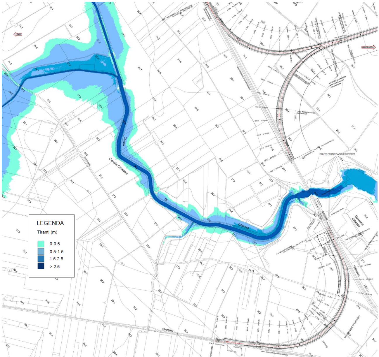
Figura 15 - Modello 2D del Canale Cillarese: aree di esondazione Tr 200.
