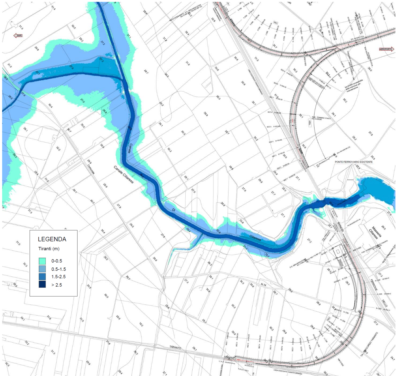
Figura 14 - Modello 2D del Canale Cillarese: aree di esondazione Tr 300.
