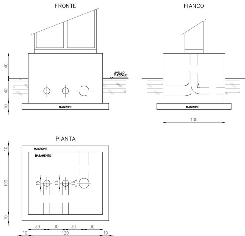
NOTA: Le canalizzazioni inglobate nei blocchi di fondazione sono indicative e dovranno essere adeguate nelle fasi progettuali successive, sulla base delle esigenze costruttive rappresentate nei layout elettromeccanici.
