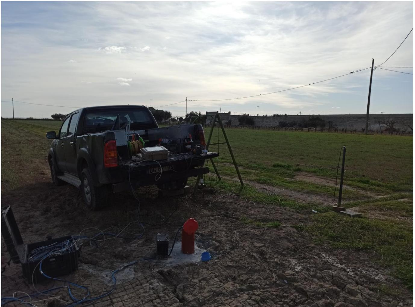
**Fig. 2:** strumentazione impiegata per le prove in foro mediante metodologia down-hole.
