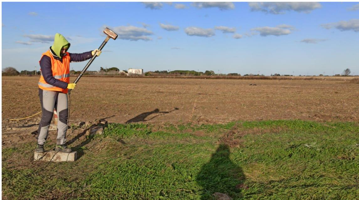
**Fig. 10:** esecuzione della prova Down-Hole BH13.
