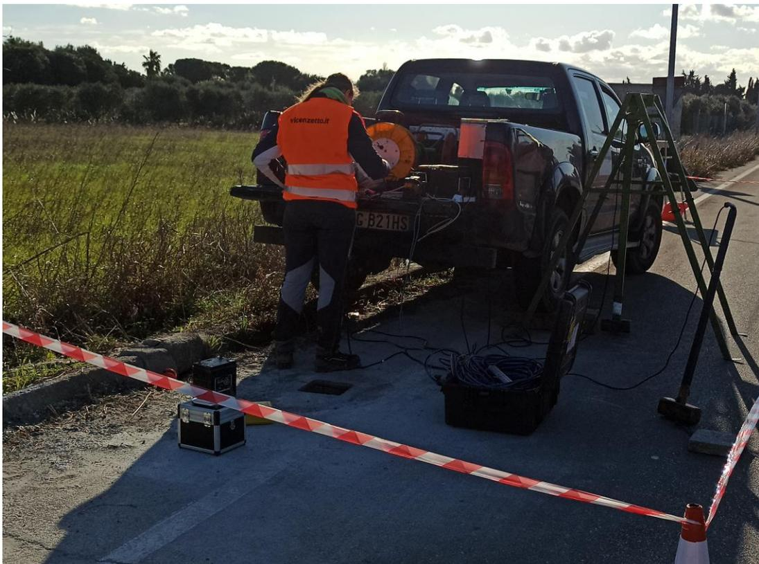
Fig. 15: esecuzione della prova Down-Hole BH14.
