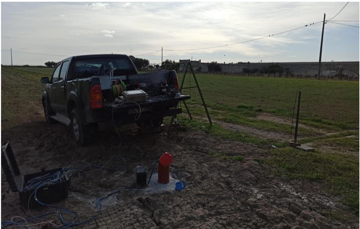
Fig. 5: esecuzione della prova Down-Hole BH12.
