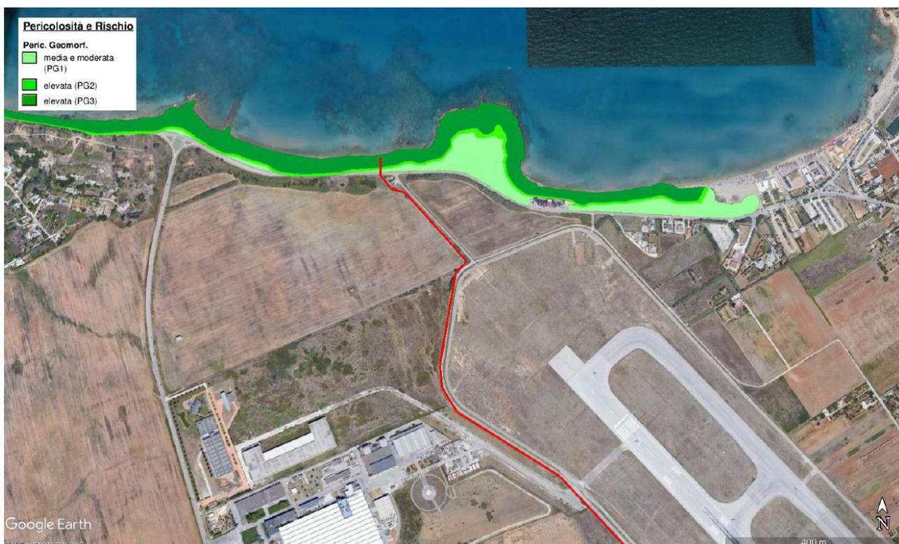
*Figura 5-5 Stralcio della carta della pericolosità geomorfologica dell'area interessata dagli interventi in progetto con dettaglio sul collettore di scarico IN16 (in rosso)*
