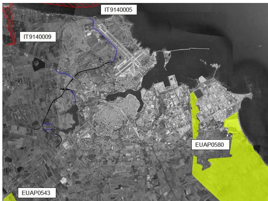
Figura 13 Tracciato di progetto su foto aerea (in nero l'asse ferroviario e le opere viarie connesse e in blu le opere idrauliche) con riportati i siti appartenenti alla Rete Natura 2000 e le aree EUAP
