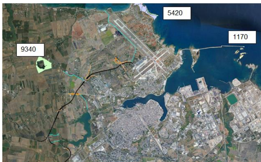
Figura 12 Tracciato di progetto su foto aerea (in nero l'asse ferroviario, arancio le opere viarie connesse e in ciano le opere idrauliche) con riportati gli habitat presenti (Fonte: Portale Puglia.con)
