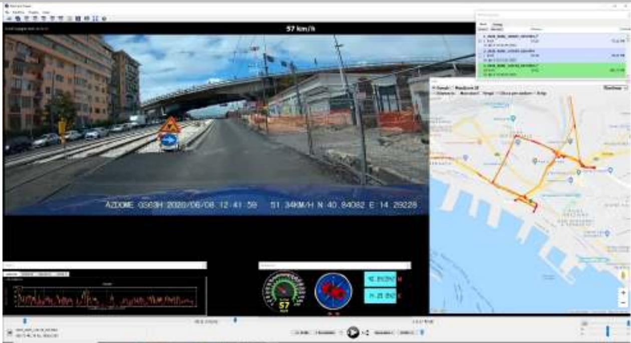
Figura 3.1.- Tracciamento del percorso e registrazione delle caratteristiche cinematiche del moto durante le indagini
