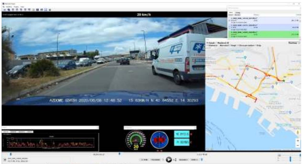
Figura 3.2.- Tracciamento del percorso e registrazione delle caratteristiche cinematiche del moto durante le indagini
