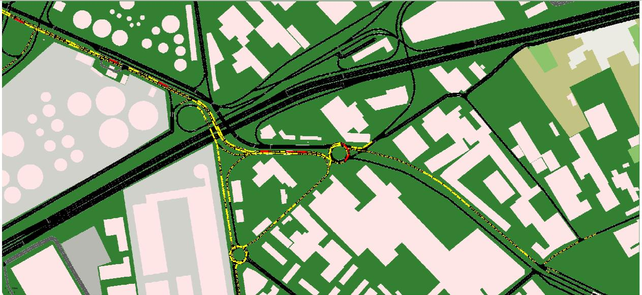
Figura 6.9- Blocco della circolazione per saturazione da traffico con un carico del 250%
