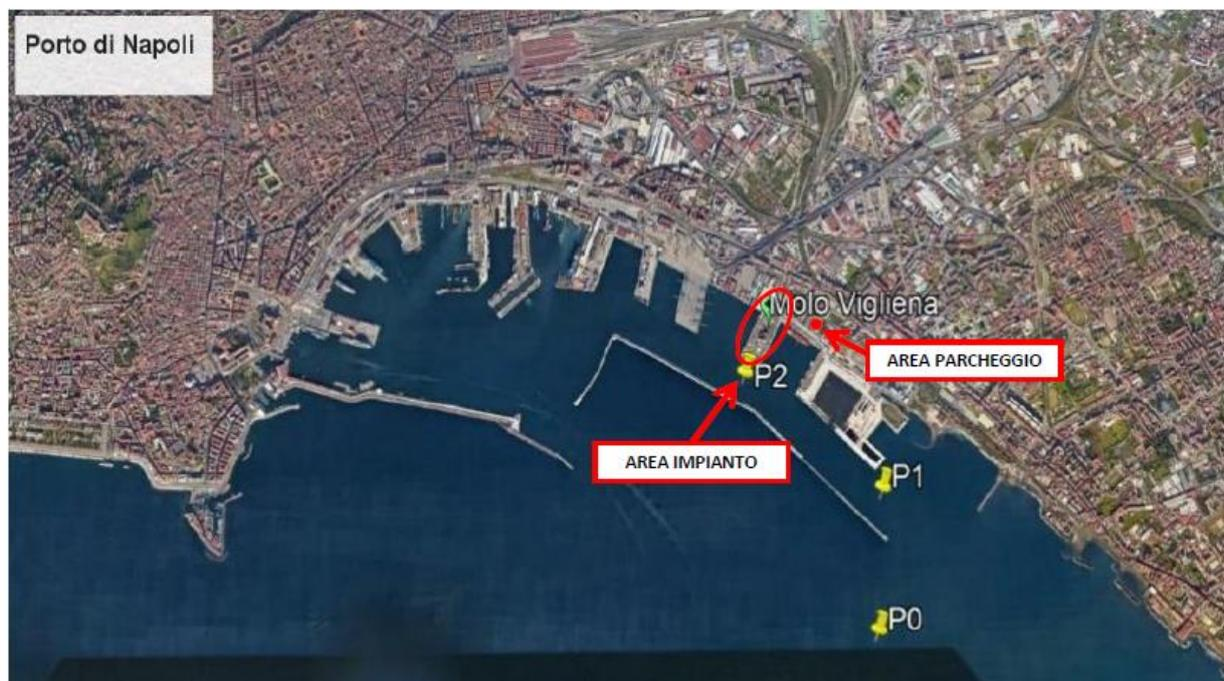
Figura 4.46: Punti di Calcolo del Moto Ondoso residuo a Costa (P0) e presso il Porto (P1 e P2)
