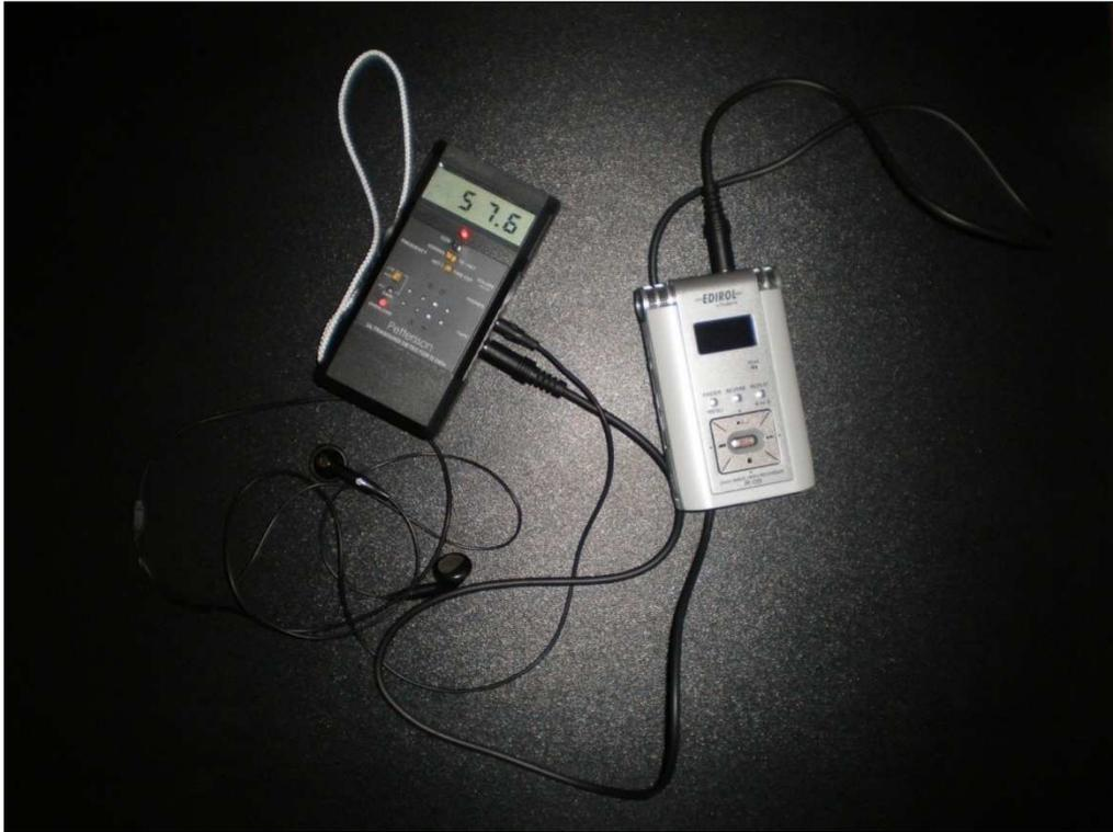
Figura 8 - Bat-detector D240X con registratore digitale Edirol R-09.
