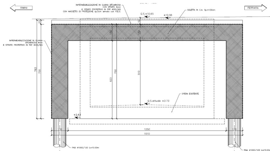
Figura 2: sezione trasversale sottopasso
