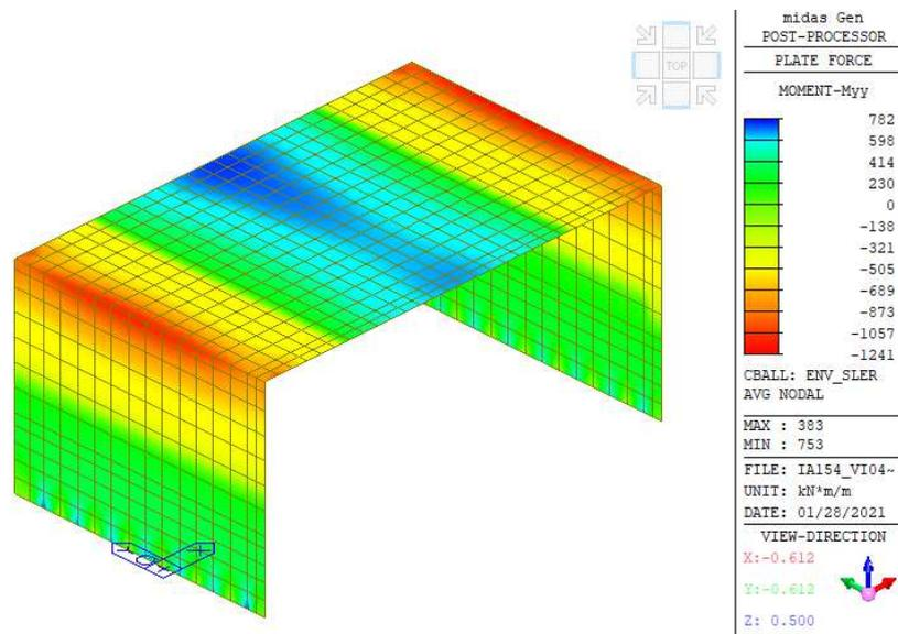
Figura 20: Verifica SLE rara per armatura: sup. 2 $\phi$ 26/20, inf. 2 $\phi$ 26/20
