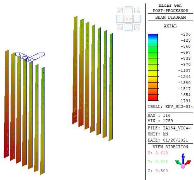
Figura 11: Involuppo sforzo normale (SLU-SIS)
