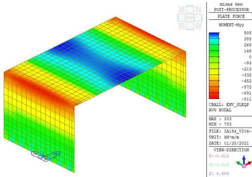
Figura 25: Verifica SLE quasi permanente per armatura: sup. 2φ26/20+1φ18/20, inf. 2φ26/20
