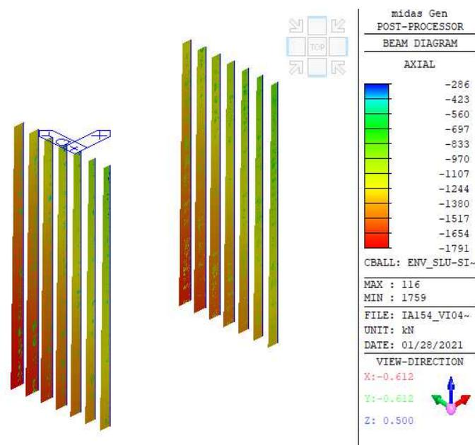
Figura 13: Involuppo sforzo normale (SLU-SIS)
