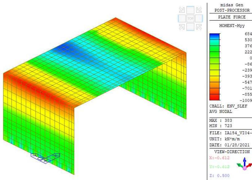
Figura 22: Verifica SLE frequente per armatura: sup. 2 $\phi$ 26/20, inf. 2 $\phi$ 26/20
