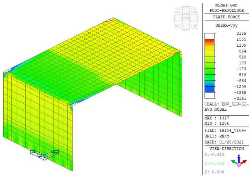
Figura 19: Verifica a taglio per armatura: 1φ12/20x40
