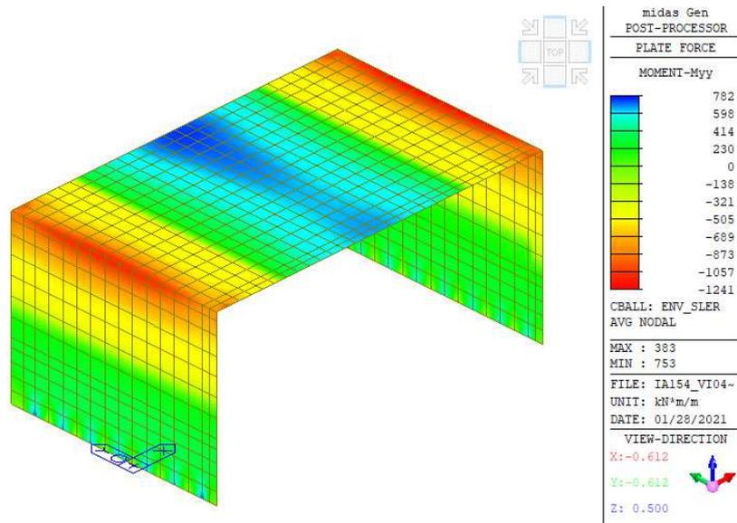
Figura 21: Verifica SLE rara per armatura: sup. 2 $\phi$ 26/20+1 $\phi$ 18/20, inf. 2 $\phi$ 26/20
