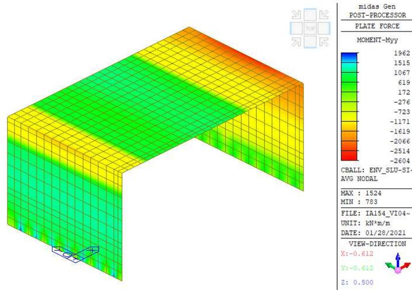
Figura 17: Verifica a flessione per armatura: sup. 2 $\phi$ 26/20+1 $\phi$ 18/20, inf. 2 $\phi$ 26/20
