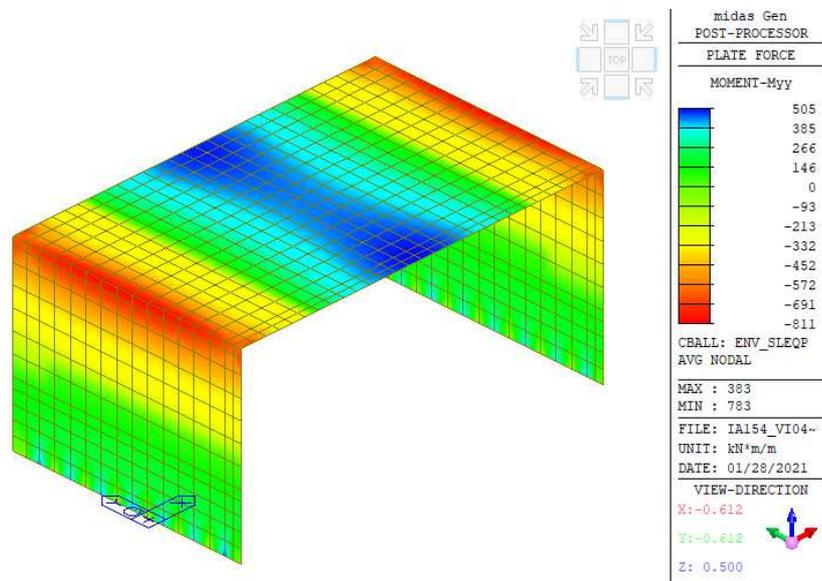
Figura 24: Verifica SLE quasi permanente per armatura: sup. 2φ26/20, inf. 2φ26/20
