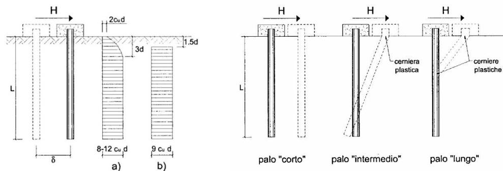
I meccanismi di rottura del complesso palo-terreno sono condizionati dalla lunghezza del palo, dal momento di plasticizzazione della sezione e dalla resistenza esercitata dal terreno. I possibili meccanismi di rottura sono riportati nella figura seguente e sono solitamente indicati come "palo corto", "intermedio" e "lungo".
