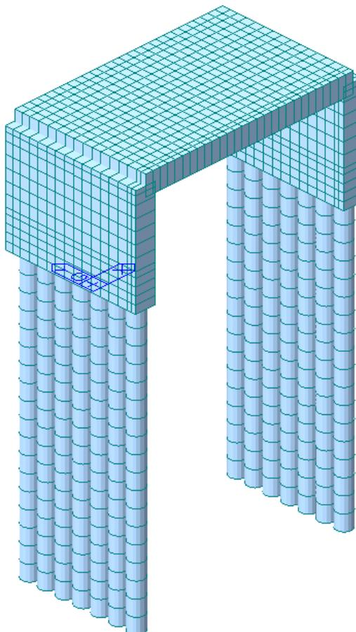
Figura 3: modello di calcolo sottopasso
