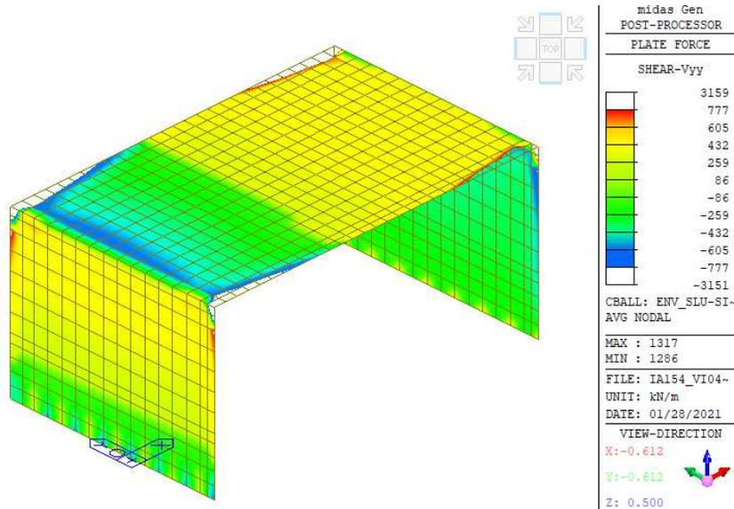
Figura 18: Verifica a taglio per armatura: 1φ12/40x40
