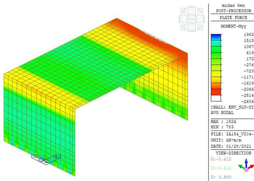
Figura 16: Verifica a flessione per armatura: sup. 2 $\phi$ 26/20, inf. 2 $\phi$ 26/20
