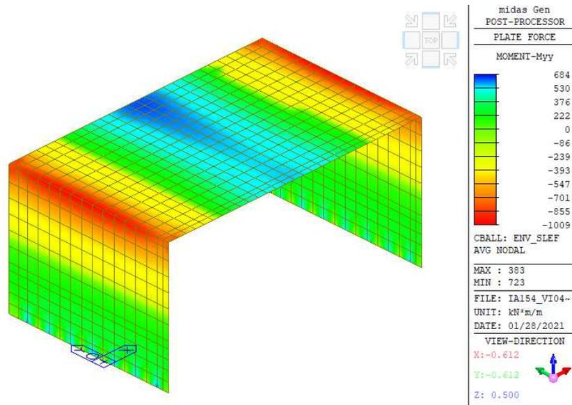
Figura 23: Verifica SLE frequente per armatura: sup. 2φ26/20+1φ18/20, inf. 2φ26/20
