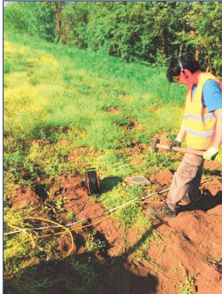
*Fig. 4.3 - Vicenza. Tomografia sismica in onde P. Fase di acquisizione dati.*
