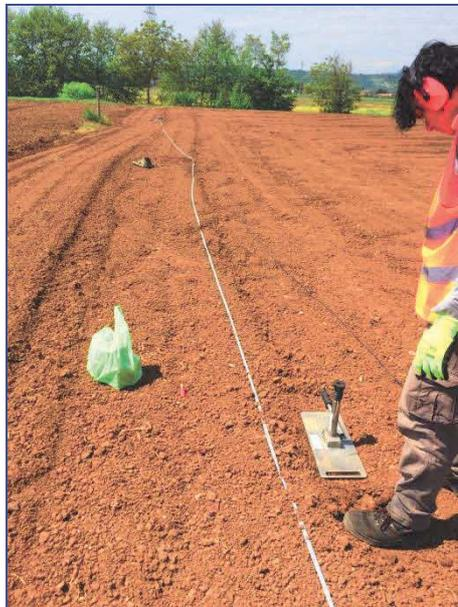
*Fig. 4.4 - Vicenza. Tomografia sismica in onde S. Fase di acquisizione dati.*
