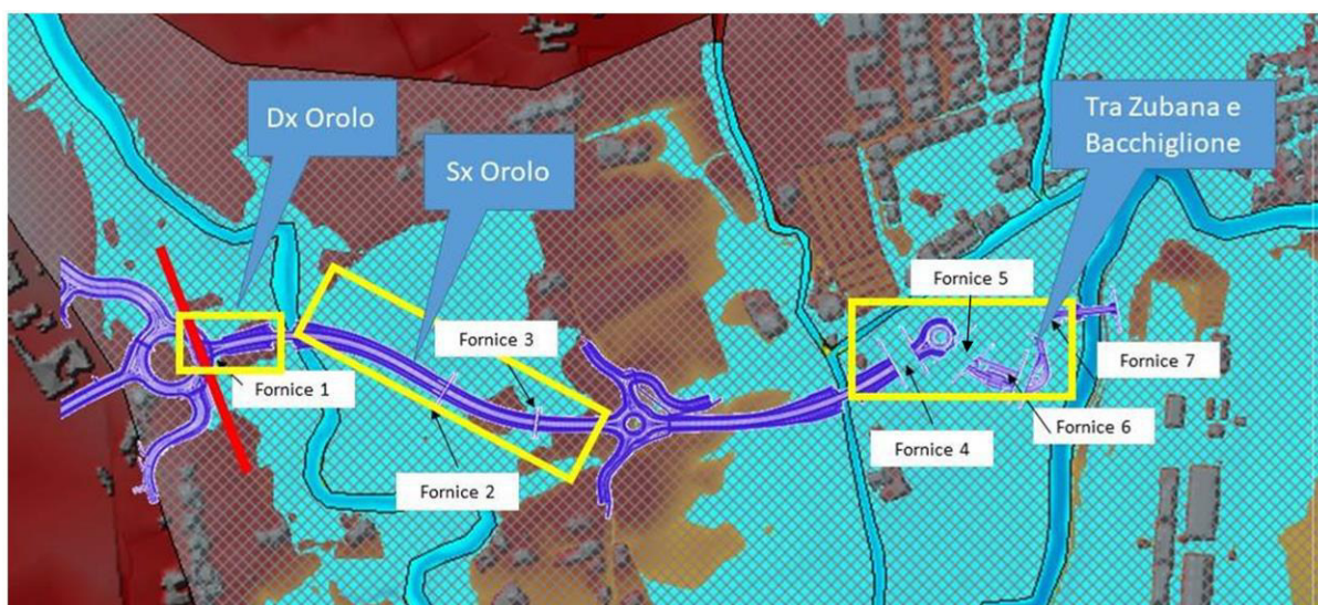
FIGURA 3-10 - SCHEMA DELLA CONFIGURAZIONE DEI FORNICI IPOTIZZATA ,SOVRAPPOSTA ALL'ESTENSIONE DELLE AREE DI ESONDAZIONE OTTENUTE DALL'INVILUPPO DEGLI SCENARI A TR=200ANNI.
