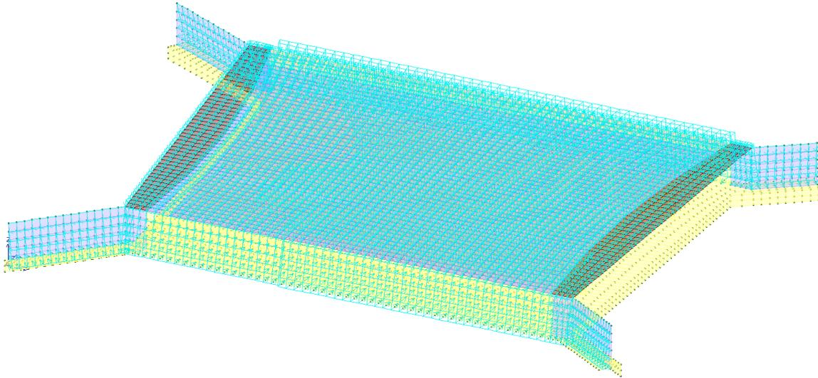
Carico del ricoprimento e del terreno a tergo dell'opera - SCH-2
