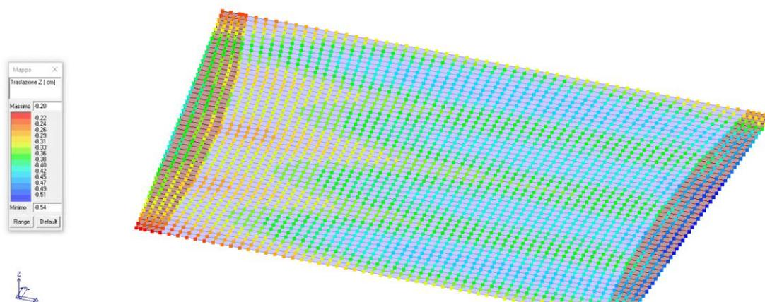
La deformazione massima della struttura allo stato limite di esercizio considerando anche il cedimento dell'intera struttura dovuta al peso proprio, che in gran parte si verificherà durante le fasi costruttive della stessa, risulta pari a:
