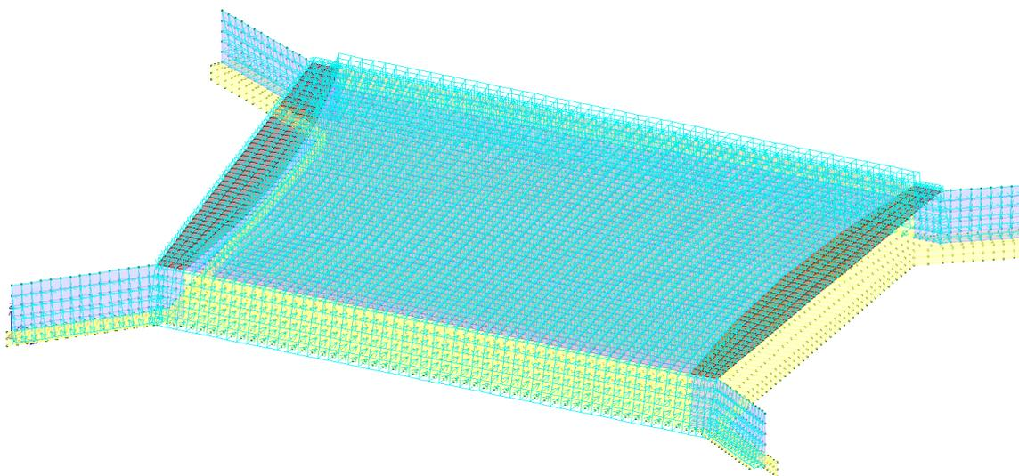
Carico del ricoprimento e del terreno a tergo dell'opera - SCH-1
