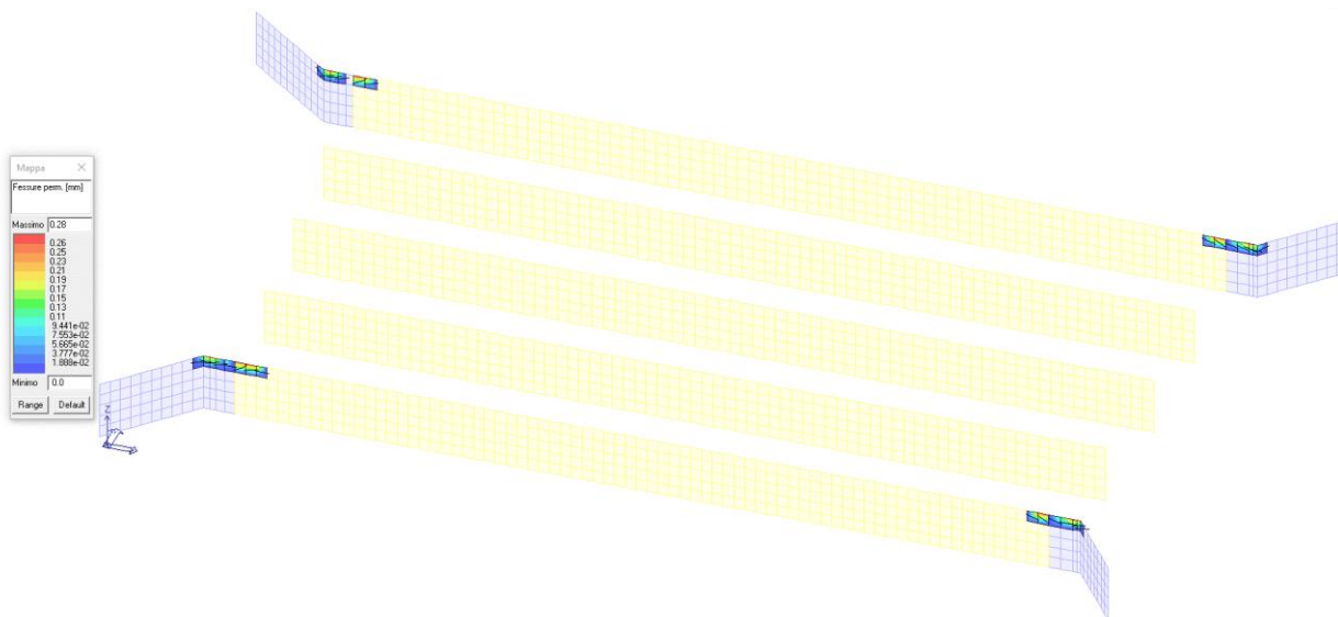
SLE – Fessurazioni in cond. permanenti
