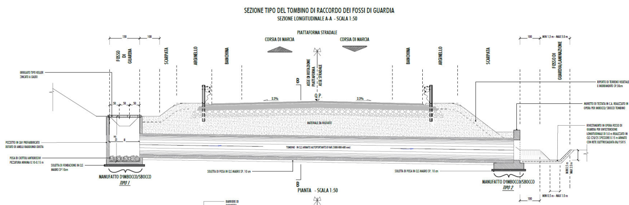
FIGURA 4-5 – SEZIONE TIPO DEL TOMBINO DI COLLEGAMENTO TRA FOSSI DI GUARDIA (COD. ELABORATO T00M02IDRDI03_A)
