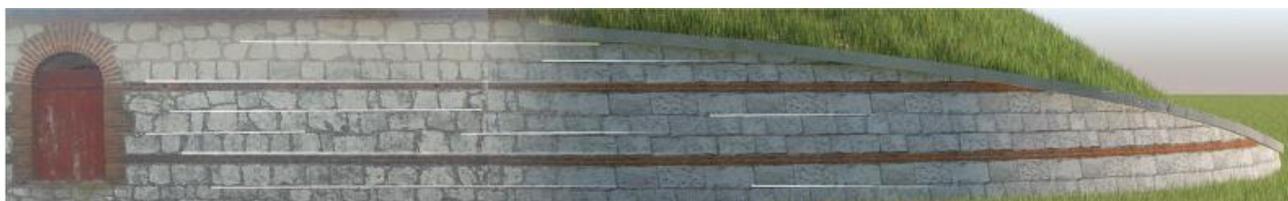
**FIGURA 2-13 CONCEPT – CONFIGURAZIONE DEL RIVESTIMENTO MURARIO DI PROGETTO**
