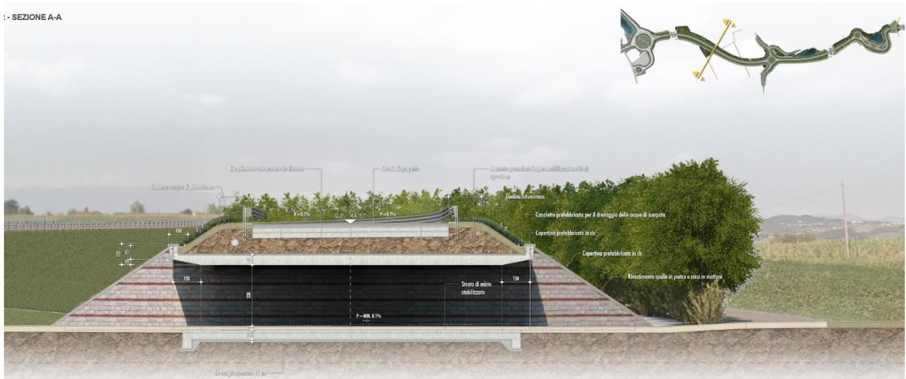
**FIGURA 5-30 SEZIONE AMBIENTALE DEL FORNICE/SOTTOPASSO AGRICOLO 02**
