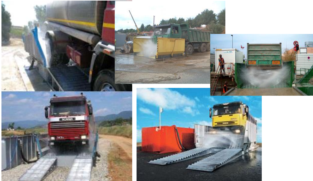
FIGURA 8-5 - SISTEMI DI LAVAGGIO DEI MEZZI AD ALTA PRESSIONE
