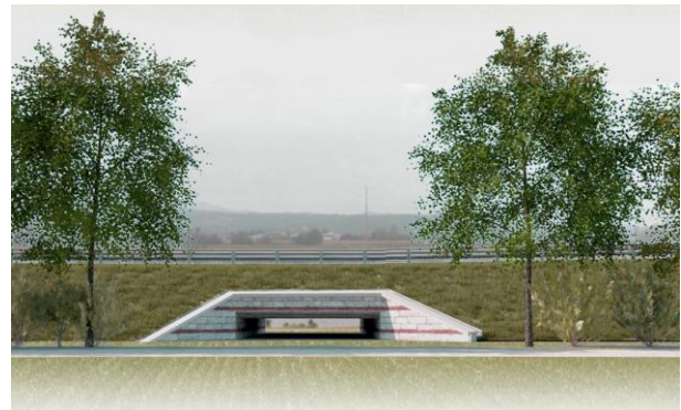
FIGURA 8-39 FORNICE, ATTRAVERSAMENTO FAUNISTICO, VISTA VIRTUALE
