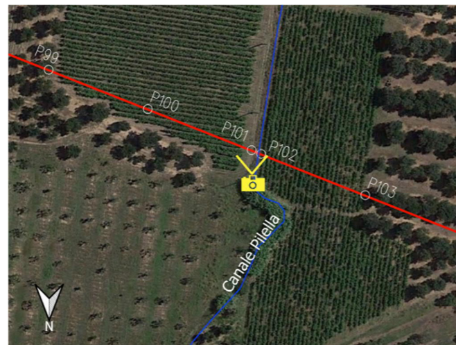
Localizzazione dell'attraversamento con indicazione del punto di ripresa fotografico. In rosso l'asse del Metanodotto
