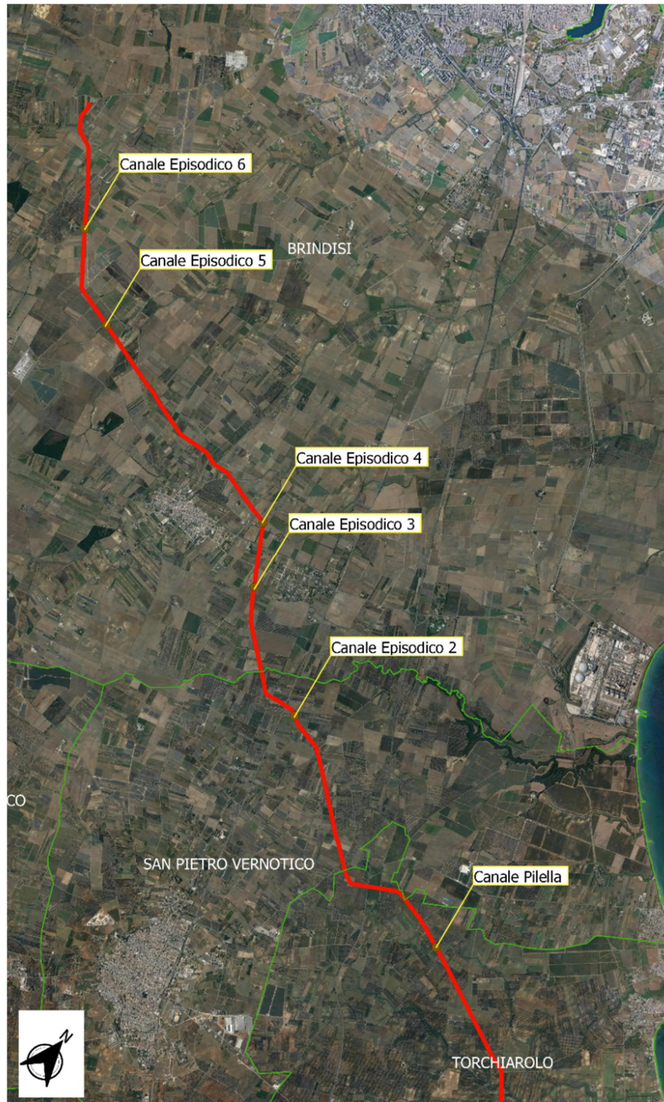
Fig. 1 – Localizzazione sul tracciato del metanodotto dei canali attraversati con scavo a cielo aperto
