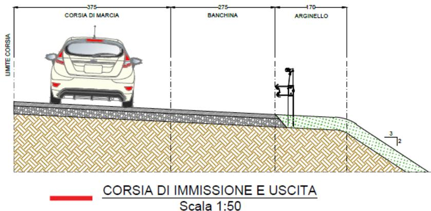
Figura 3-5 Sezione tipo corsia di immissione e uscita
