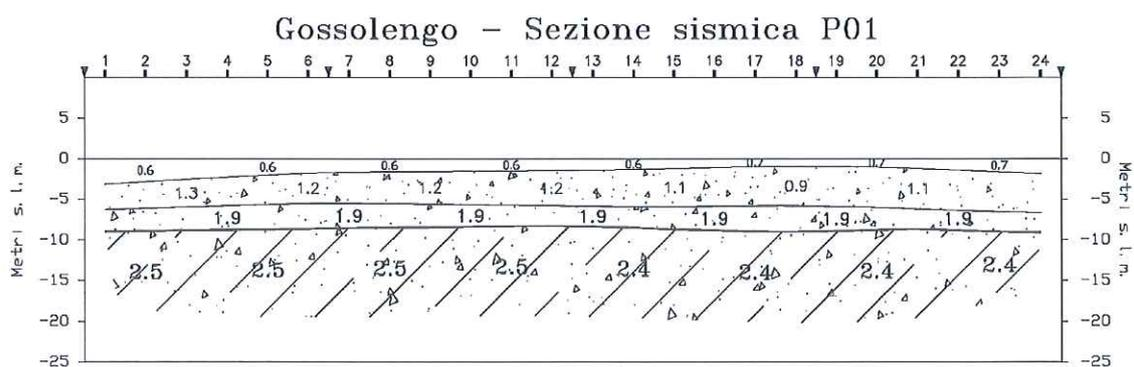
Fig. n°9: Sezione sismostratigrafica
