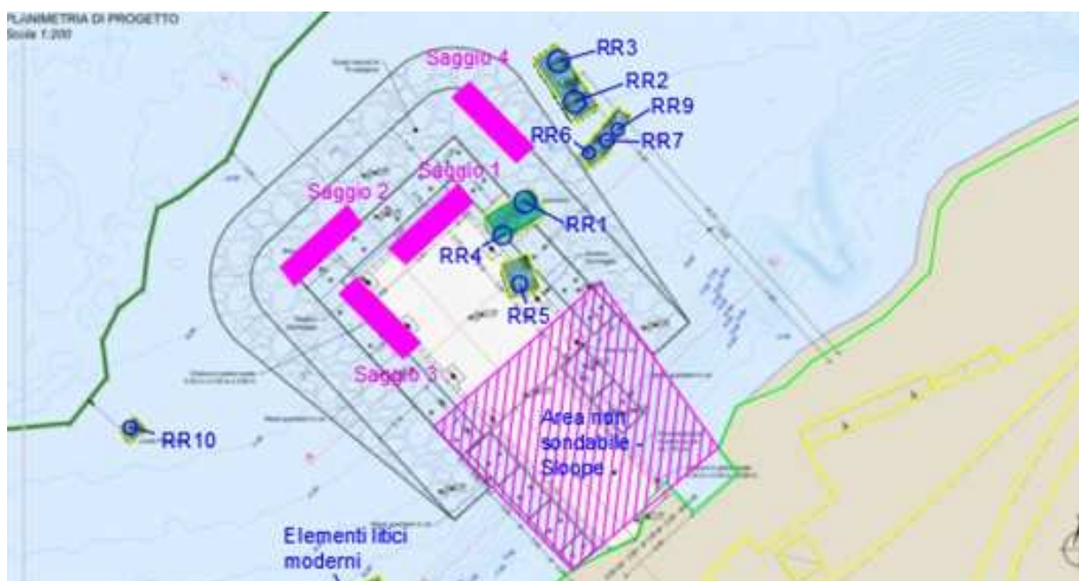
Figura 31 – Sovrapposizione planimetria di progetto con aree indagate (saggi 1, 2, 3, e 4) e l'evidenziazione delle emergenze già individuate nella precedente campagna
