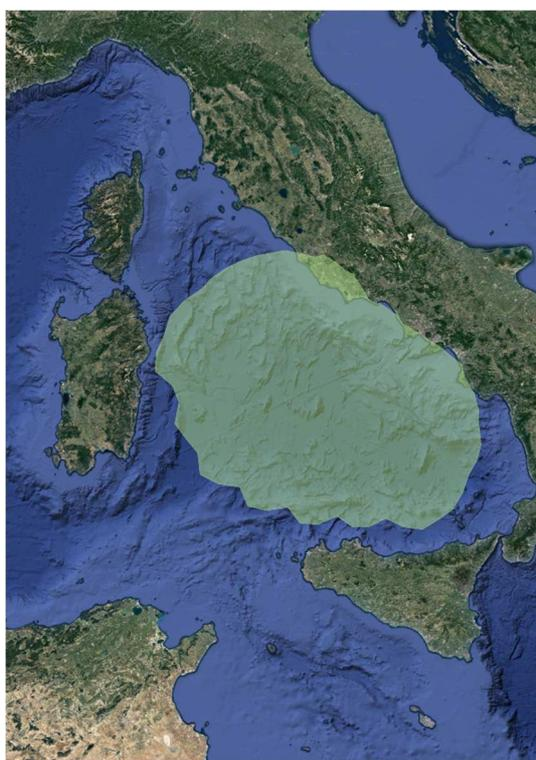
**Figura 8: Tracciamento dei fetch efficaci per il paraggio dell'Isola di Santo Stefano**
