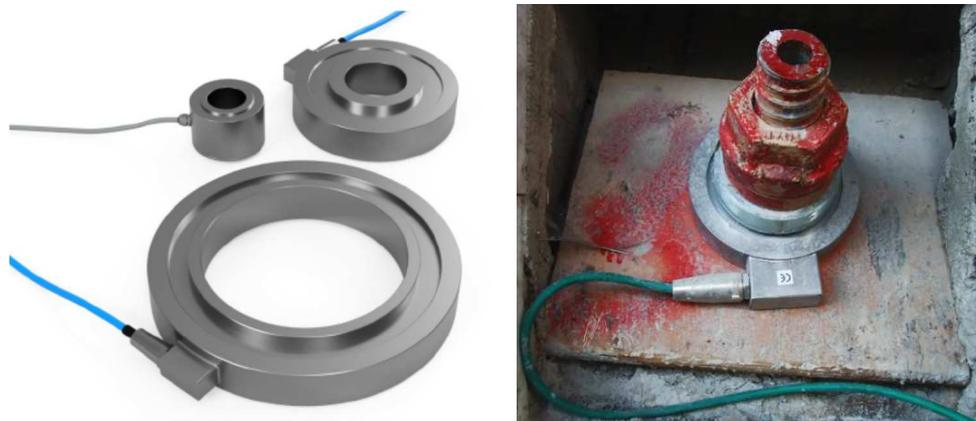
Figura 36: Celle di carico toroidali elettriche
