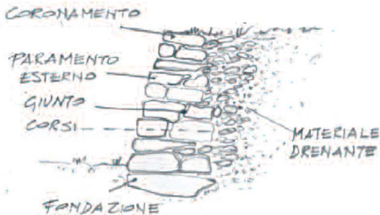
Figura 8: muri a secco nomenclatura
