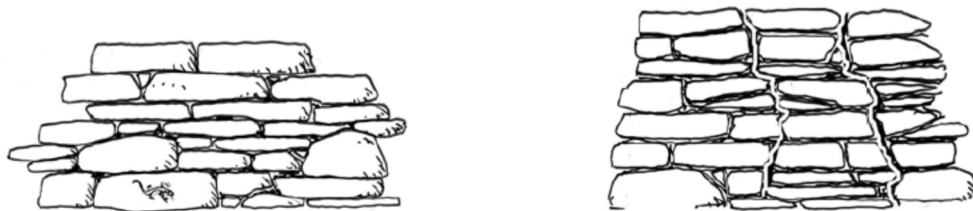
Figura 13: Montaggio corretto a sinistra ed errato a destra per la formazione di giunti verticali
