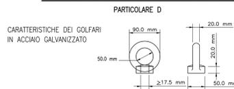
ESEMPIO DI SISTEMA DI ANCORAGGIO PER RETE
