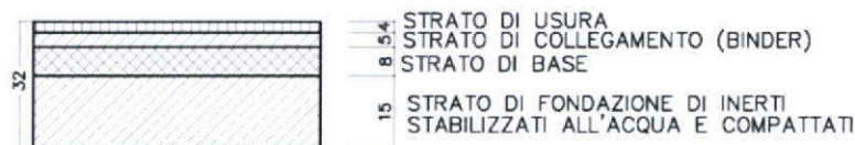
Figura 4 – Particolare pacchetto pavimentazione
