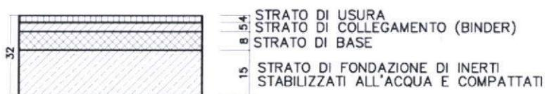
Figura 4 – Particolare pacchetto pavimentazione
