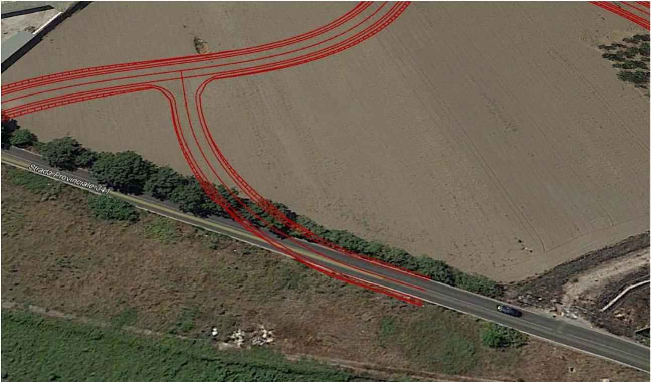
*Figura 5-24 - Esempio di interferenza con la vegetazione esistente (Ramo 17)*
